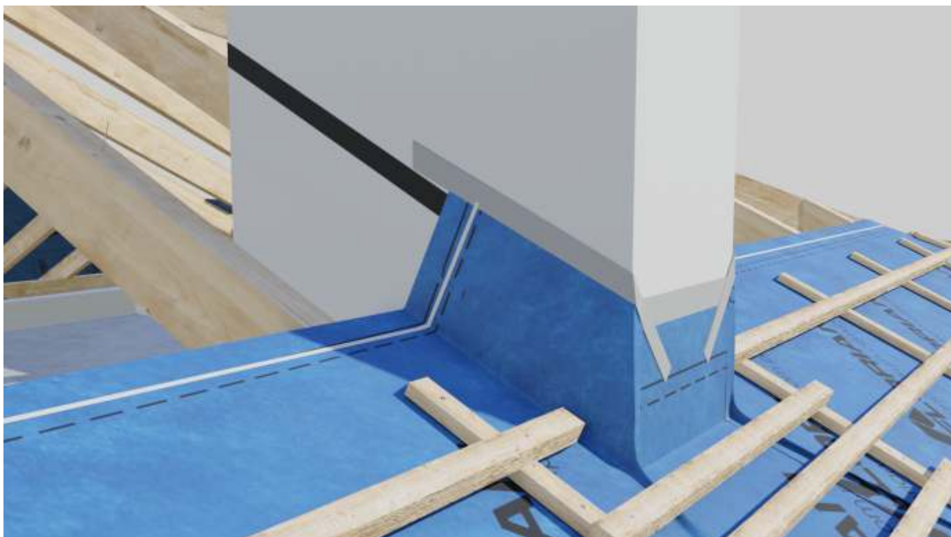
Taśma dwustronna łącząca membrany.
