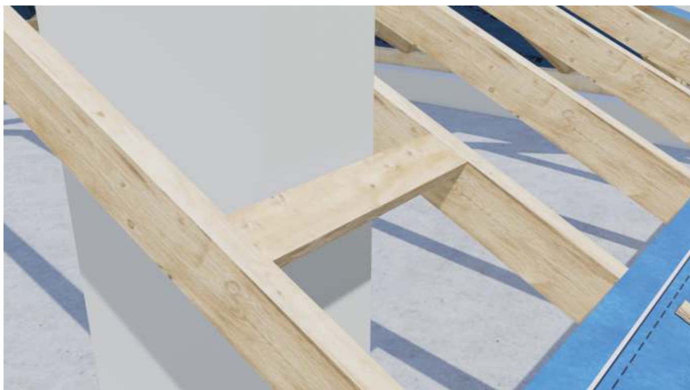
Montaż dodatkowej deski pod kominem.
