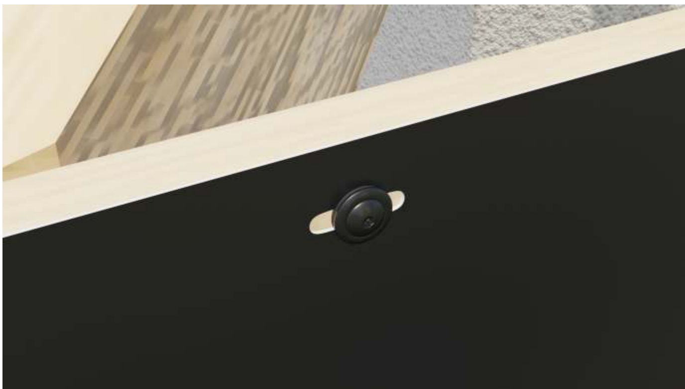
Wkręt torx wkręcony w fasolkę w obróbcę.
