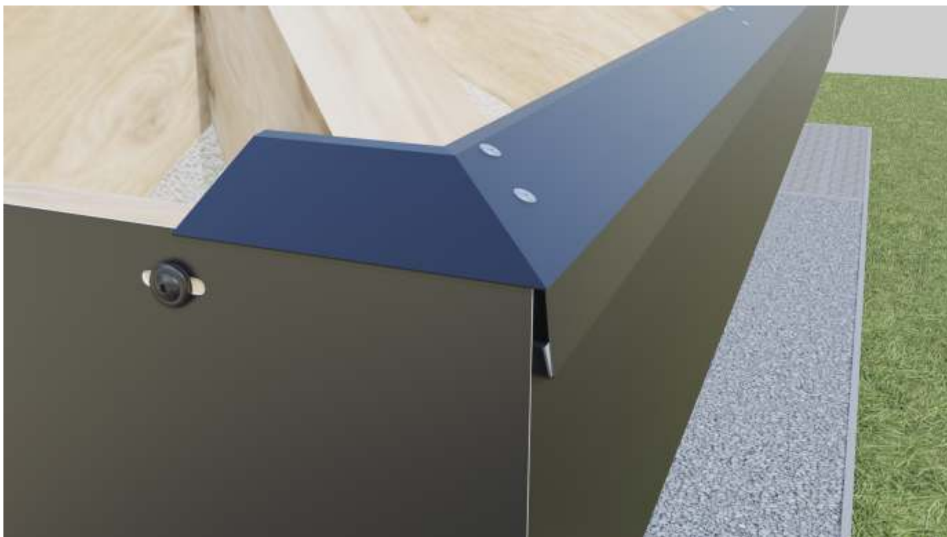
Łączenie obróbek okapu na zakładkę w narożniku.
