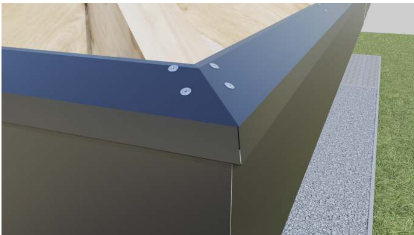
Łączenie obróbek okapu na zakładkę w narożniku.
