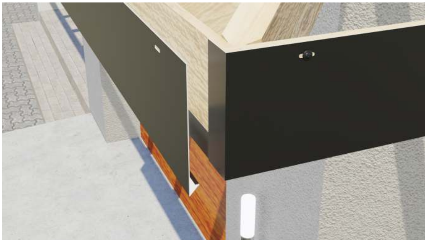
Przykład łączenia pasów podrynnowych na rogu.
